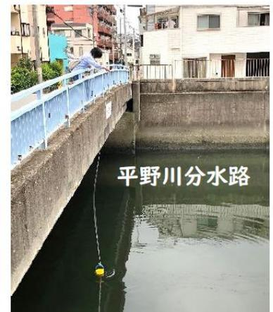
簡単な水質調査キットで COD（化学的酸素要求量）を測定し水質汚濁を調べます。
