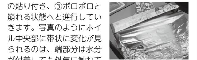
の貼り付き、③ボロボロと崩れる状態へと進行していきます。写真のようにホイル中央部に帯状に変化が見られるのは、端部分は水分が付着しても外気に触れて乾きやすい一方で、中央部分は水分がとどまりやすく乾きにくいからです。
