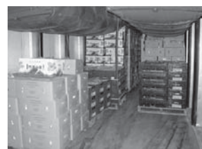
バナナを追熟させるムロ。いったん20℃くらいに温度を上げて徐々に冷やしていきます
